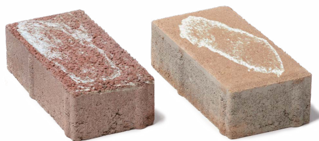
Dlažba s výkvětem
