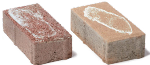
Dlažba s výkvětem
