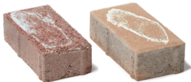
Dlažba s výkvětem
