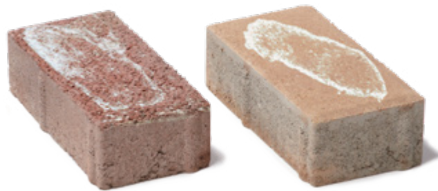
Dlažba s výkvětem
