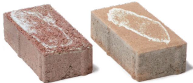
Dlažba s výkvětem
